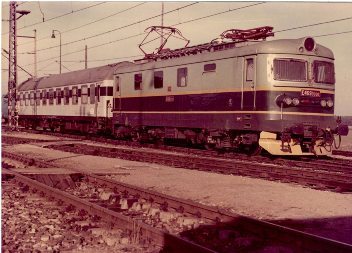
Obr.3 Lokomotiva typu 57E řady E 469.3 s podvozky na 200 km/h při zkouškách na okruhu VÚŽ, sbírka František Palík
